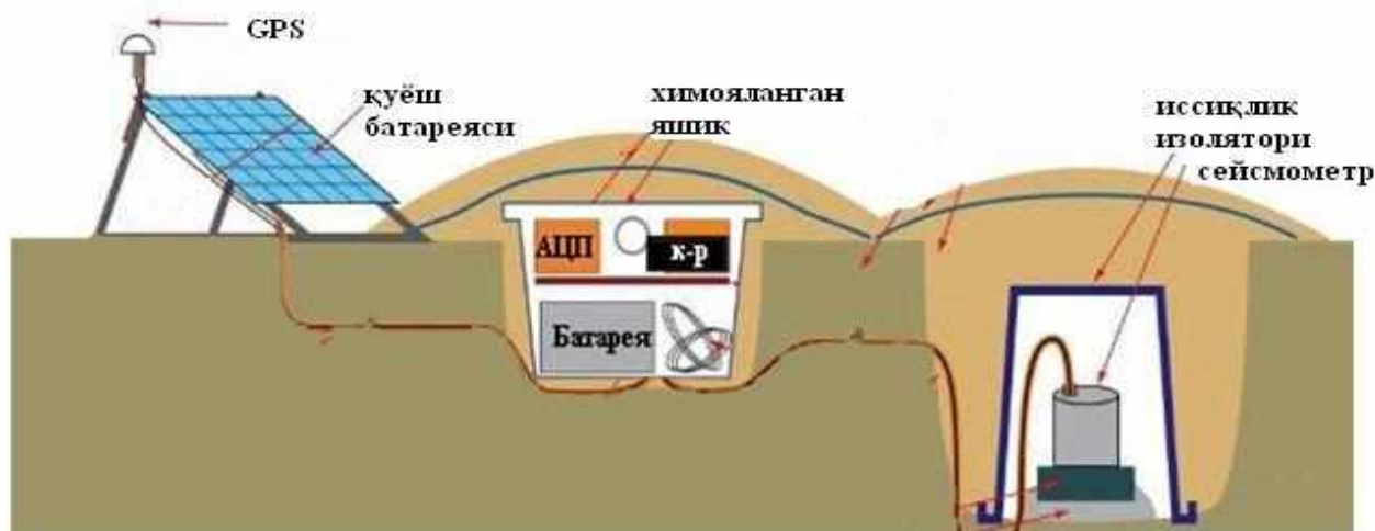
5-расм. Халқаро стандартларга мос дала сейсмик станция
